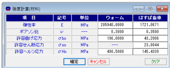
図 37.16 強度計算 (材料)
