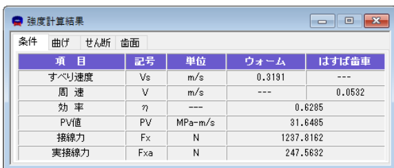
図 37.17 強度計算 (条件)
